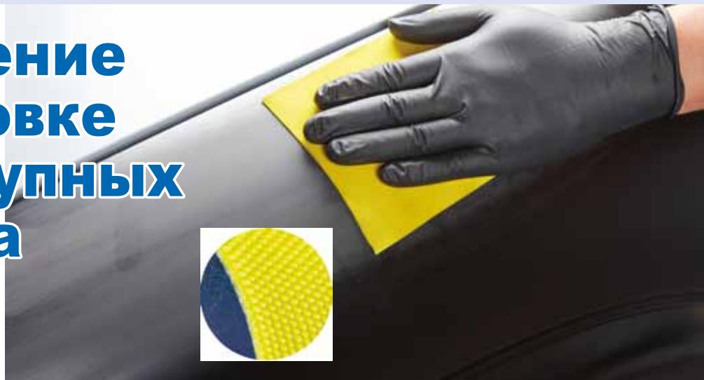
Одним из наиболее трудоемких процессов в ремонтной окраске автомобиля является подготовка поверхности. Если рассматривать детально, большую часть этих работ удалось автоматизировать и основные объемы шлифовки сегодня осуществляются с помощью шлифовальной машинки.
